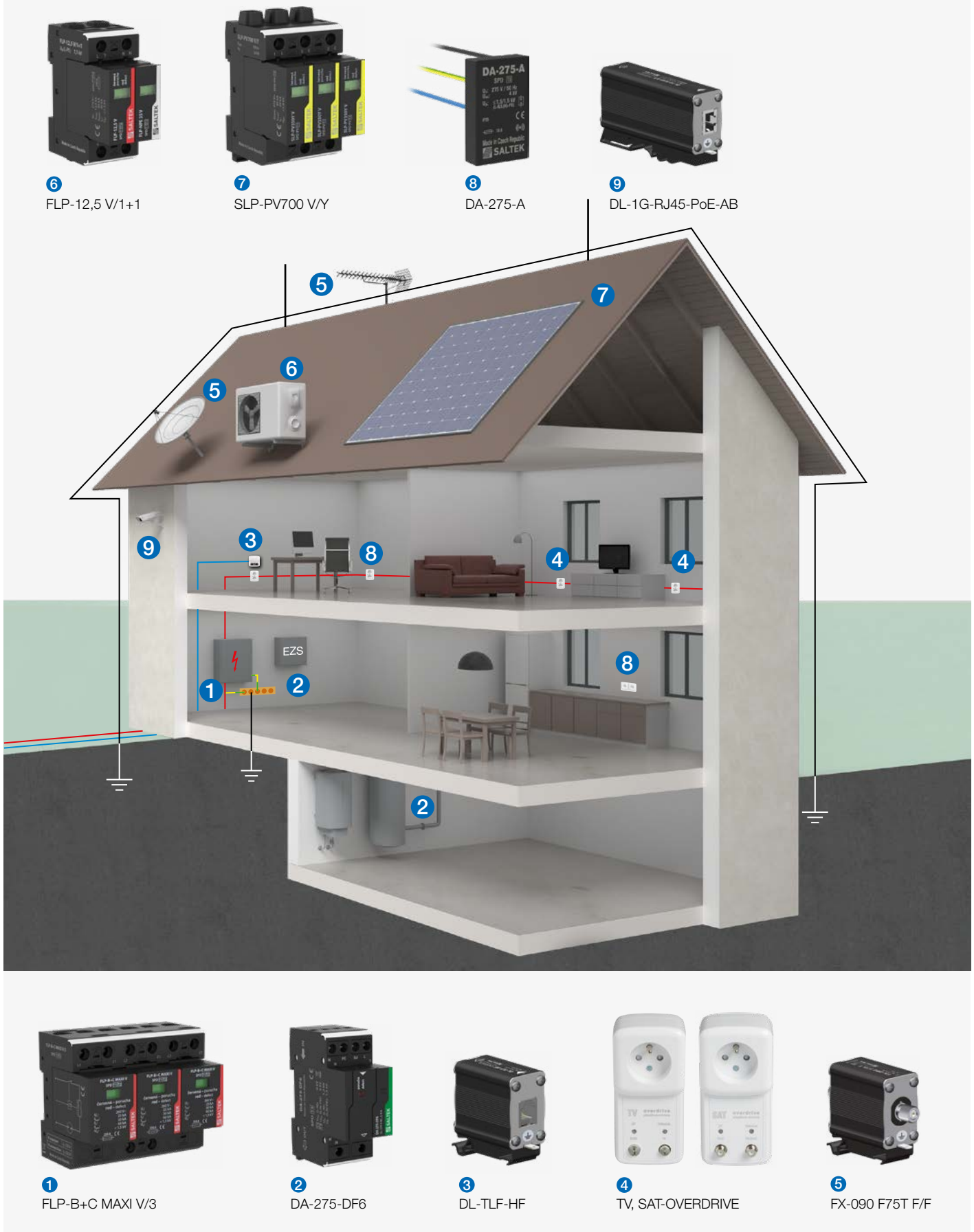
obr. 1 Příklad instalace přepětových ochran v rodinném domě
