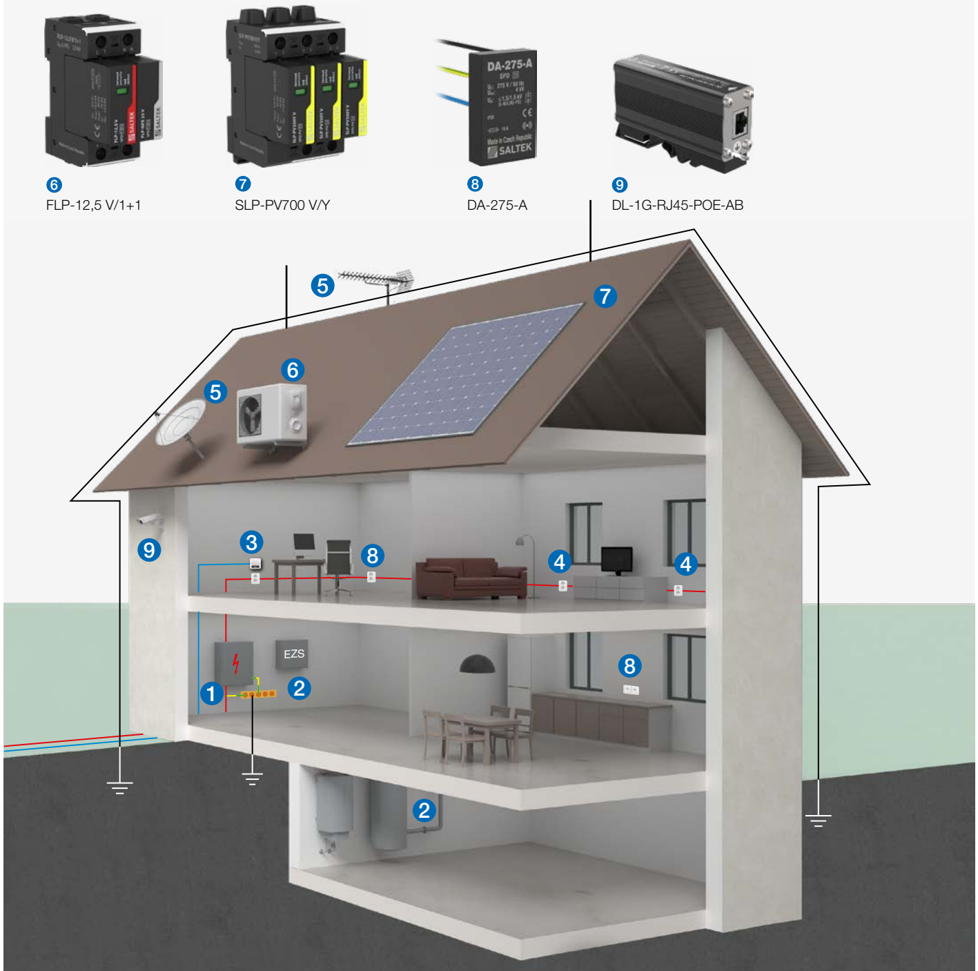
obr. 1 Příklad instalace přepětových ochran v rodinném domě
