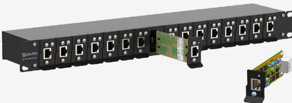
obr. 6 Multikanálová ochrana systémem zásuvných Plug&Play modulů do boxu DL-PL-RACK-1U
