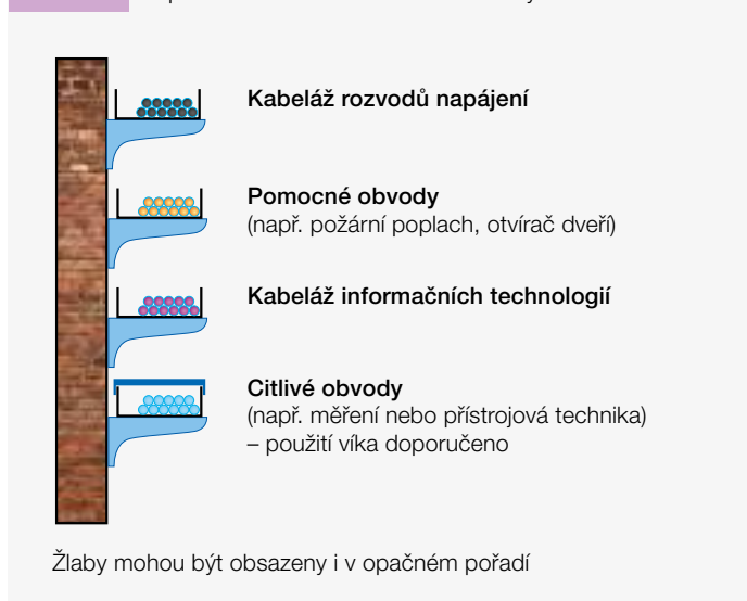
obr. 12 Doporučené uložení kabelů do kabelových žlabů
