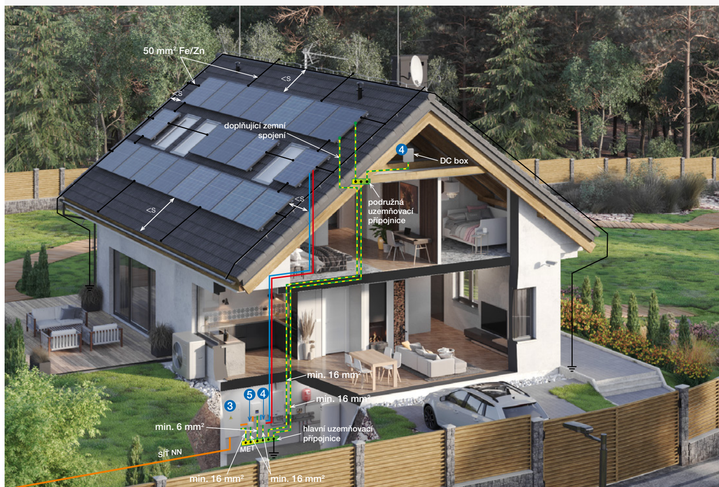
obr. 5 Nedodržená přesková vzdálenost „s“ mezi PV panely a hromosvodnou soustavou
